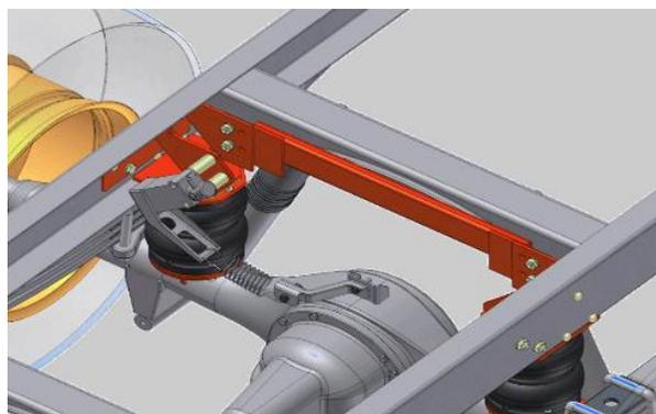
**Пневматическая система Ru-Air - это комплект дополнительного оборудования при монтаже которого не вносятся изменения в конструкцию автомобиля.**
